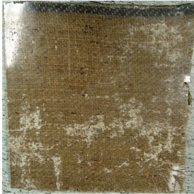
Obr. 25. Příklad desky vyrobeného sendviče o rozměrech 300mm x 300mm (ruční laminace + vakuum)
