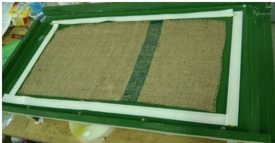
Obr. 20. Položené tkaniny s těsnící páskou okolo.
