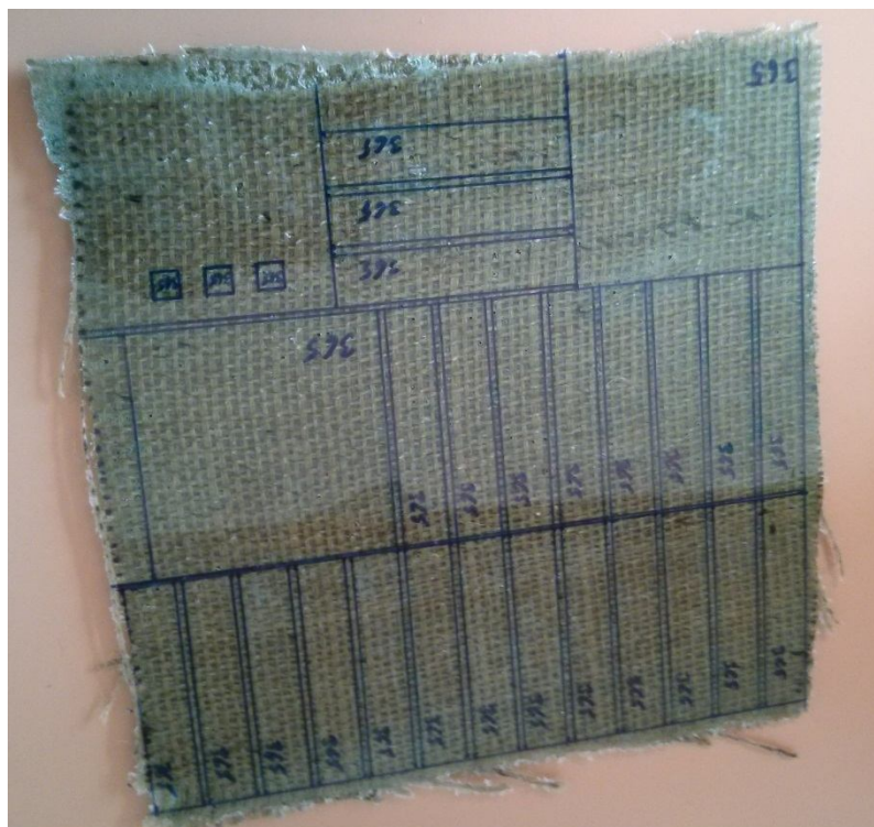
Obr. 19. Příklad vyrobeného laminátu o rozměrech 300mm x 300mm (ruční laminace).
