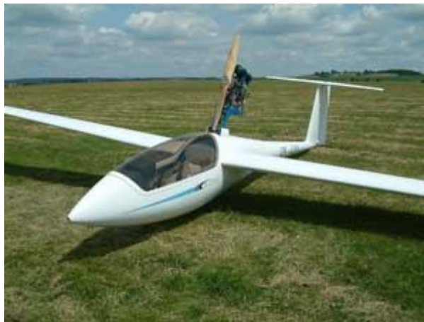
Obr. 1. Kluzák TST-10M, jehož konstrukce je tvořena skelnými lamináty [4]
