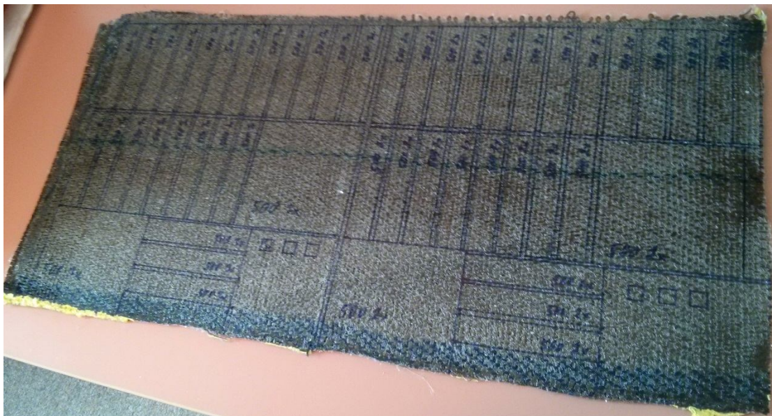
Obr. 23. Příklad vyrobeného kompozitu o rozměrech 600mm x 300mm (vakuová infuze).
