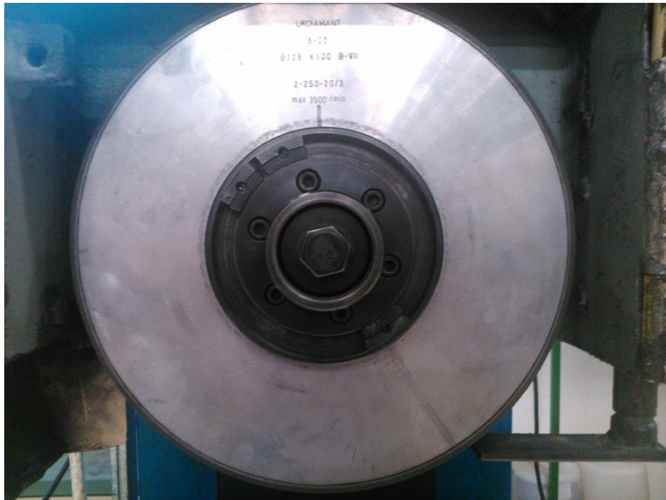
Obr. 20. Brousící kotouč se zrny kubického nitridu boru.
