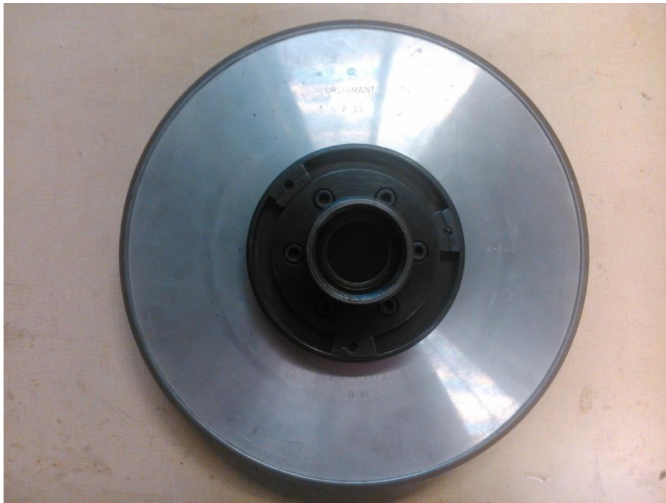
Obr. 21. Broušící kotouč se zrna diamantu.
