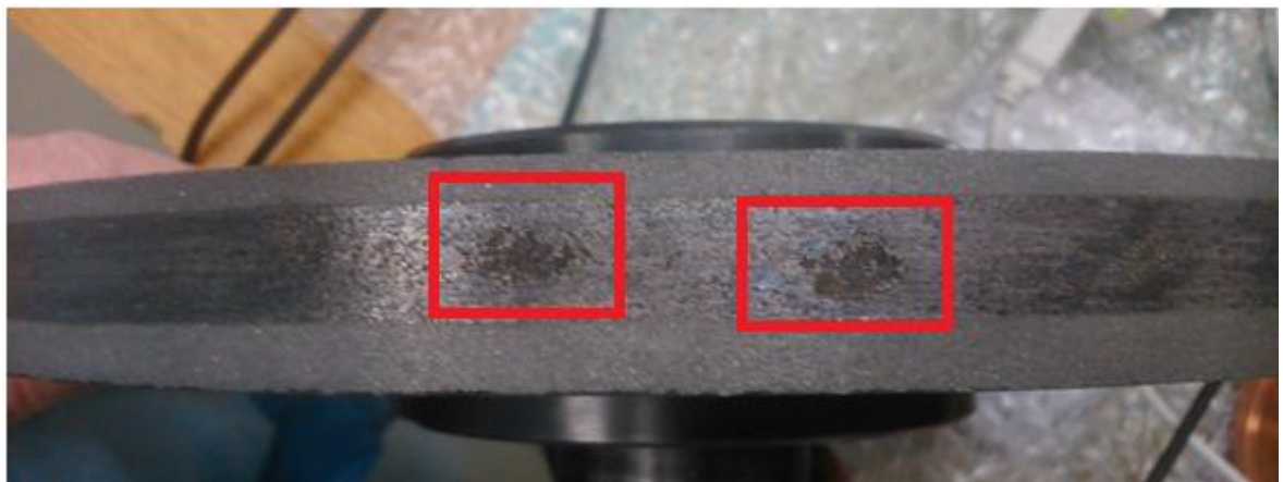
Obr. 31. Opotřebené plošky brousícího kotouče.
