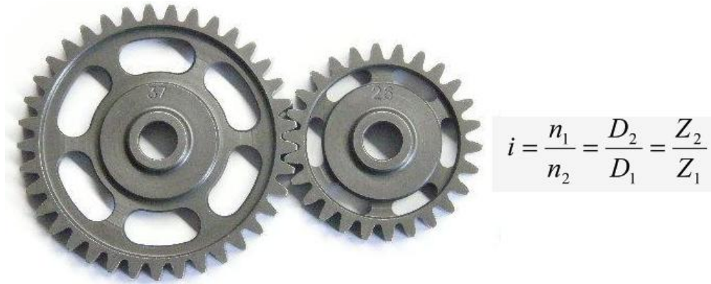
Obr. 13. Tvarové spojení přímé: ozubenými koly, [2]
