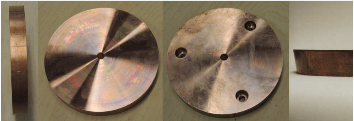
Obr. 59 Krok 1 až 4 při výrobě vložky vstřikovací formy
