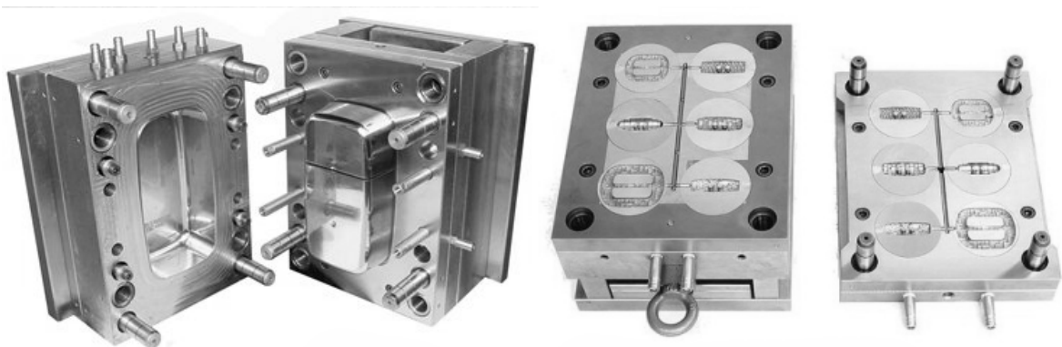
Obr. 48 Ukázka konstrukce jednonásobné a vícenásobné vstřikovací formy [14]
