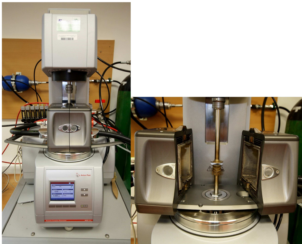
Obr. 24: Rotační reometr Anton Paar MCR 502 (vlevo celkový pohled, vpravo detail měřicí cely s geometriemi deska-deska).
