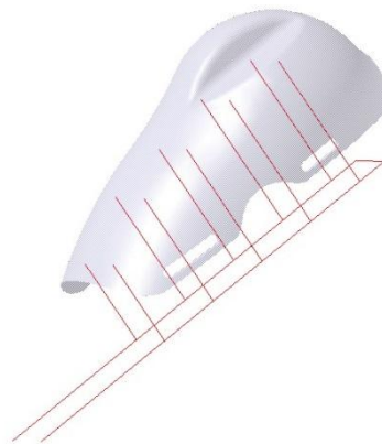
Obrázek 34 Temperační systém levé strany chrániče loktu
