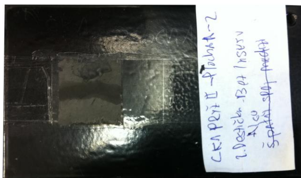
Obr. 52 Ukázka selhání (RC) pryže 102B s lakovaným kovem po vulkanizaci
