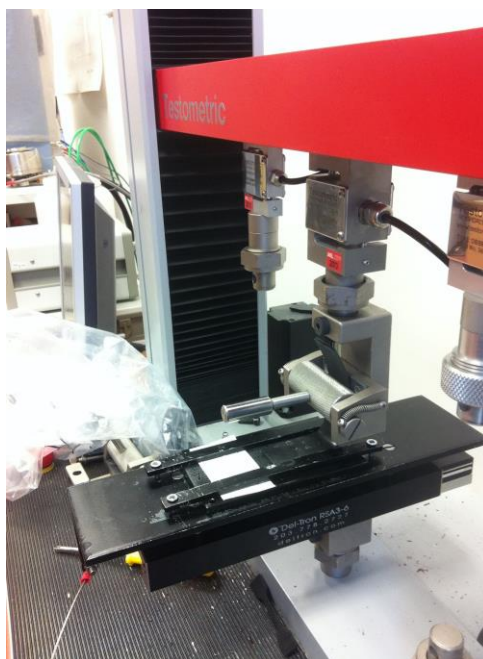
Obr. 42 Upnutí zkušebního vzorku do upínací čelisti
