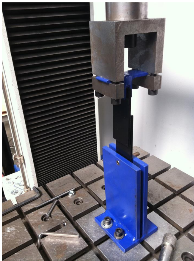
Obr. 45 Upnutí vzorku na speciálním přípravku
