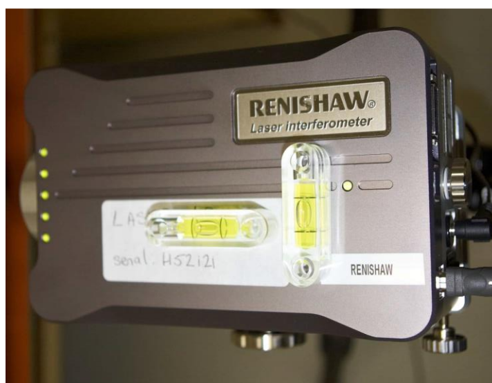
obr. 44 Ustavení laseru do roviny
