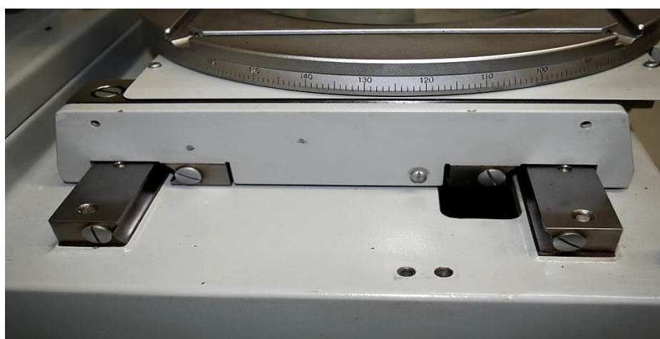
obr. 41 Vodící prvky polohování mikroskopu
