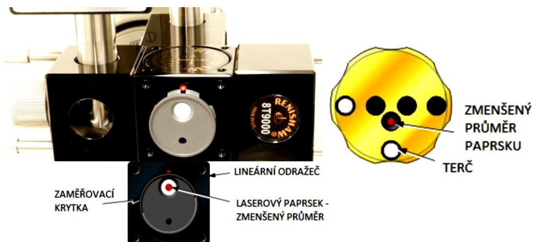
obr. 58 Zaměření paprsku na lineární odražeč se zaměřovací krytkou
