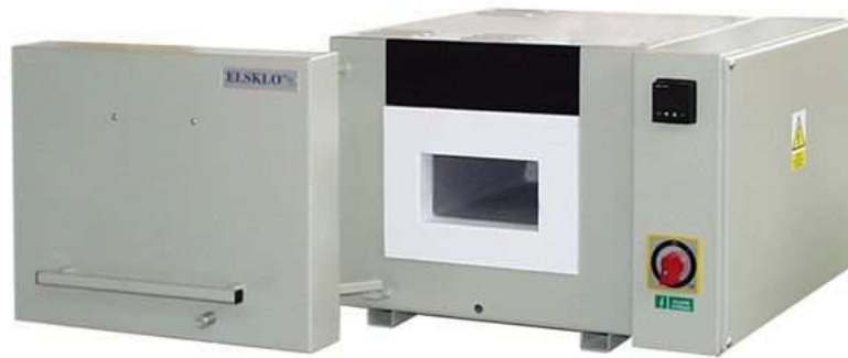
Obrázek č. 6: Laboratorní muflová pec [60]
