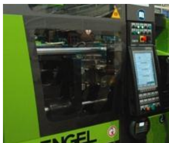
Obrázek 10.: Řídící jednotka vstřikovacího stroje
