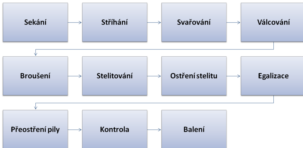
Obrázek 16 – Schéma výrobního postupu stelitovaného pásu (vlastní zpracování)
