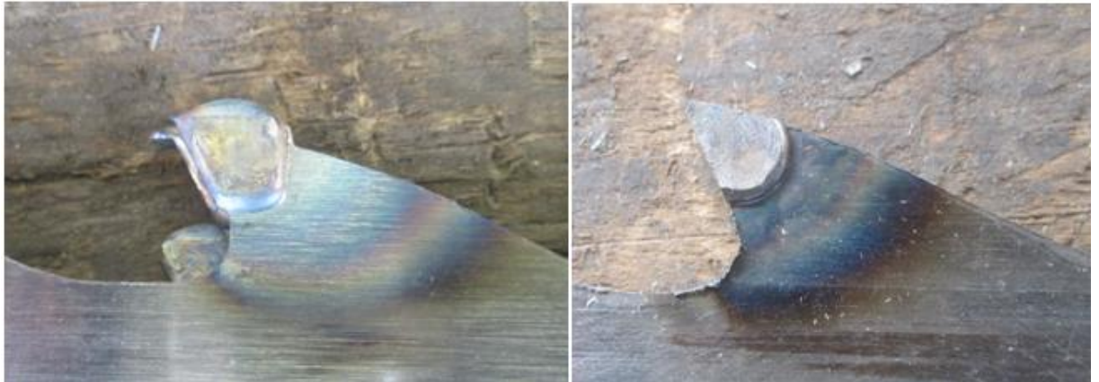
Obrázek 23 – Před ostřením stelitu a po ostření stelitu (vlastní zpracování)
