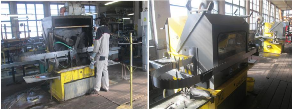
Obrázek 21 – Broušení, ostření stelitu přeostření pily (vlastní zpracování)
