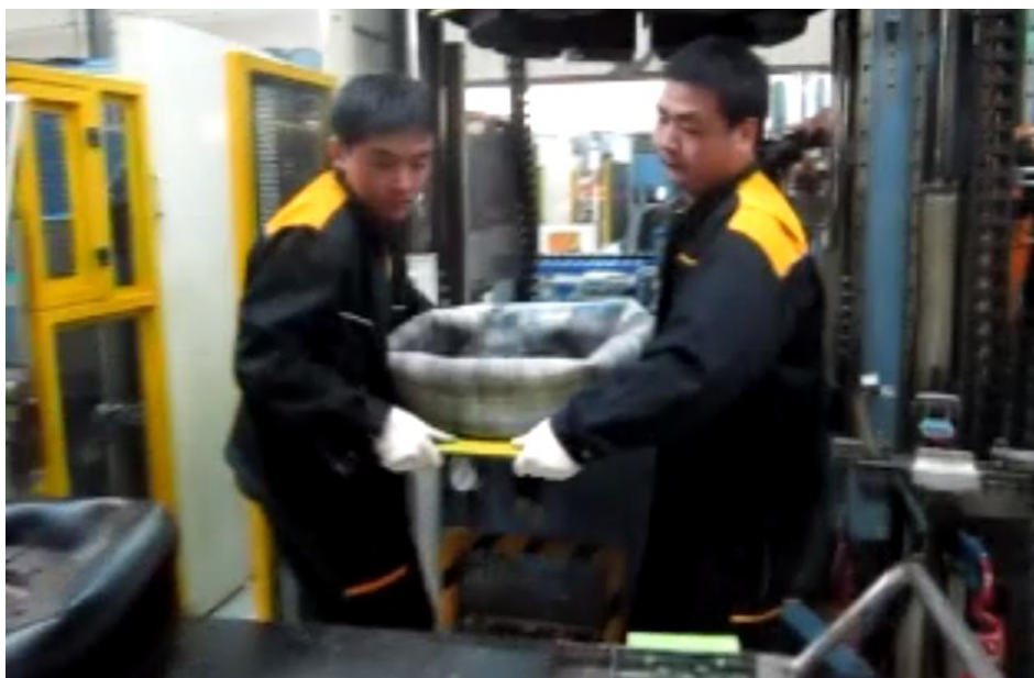
Obrázok č. 58 – Návrh nového stavu nasadenia membrány (vlastné spracovanie)
