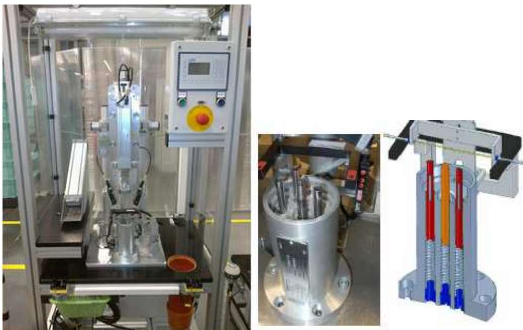
Obrázek 22 Pneumatický lis a jeho montážní přípravky (interní materiály)
