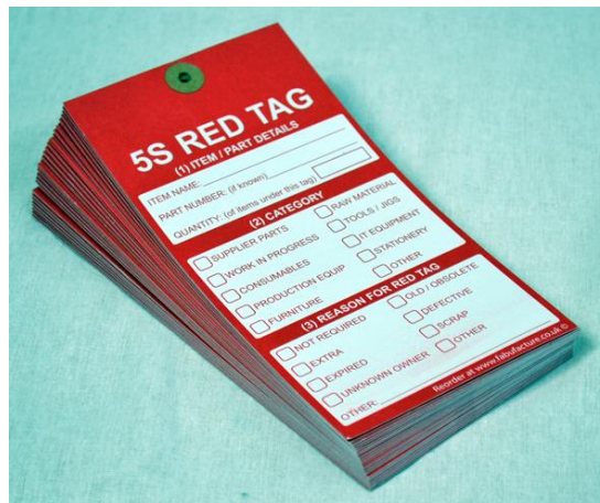
Obr. 4. Červená visačka sloužící ke třídění v 5S (Fabufecture, © 2014)
