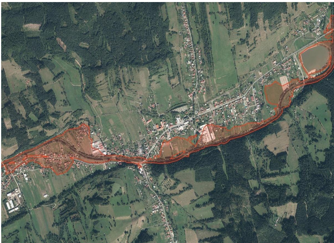
Obrázek č. 6: GIS – znázornění průtoku stoleté vody Novým Hrozenkovem
