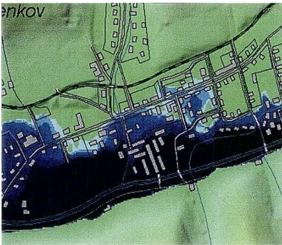
Obrázek č. 7: Simulovaná varianta průtoku ZPV Novým Hrozenkovem
