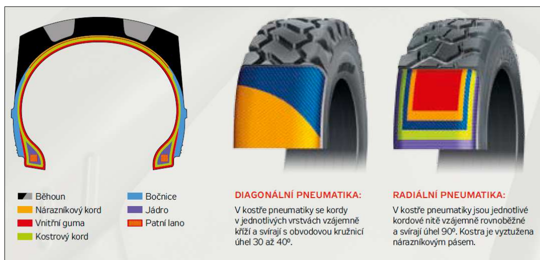
Obrázek 9: Konstrukce pneumatik.[30]
