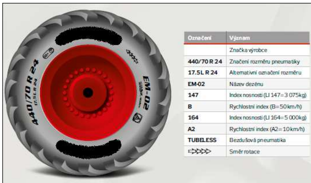
Obrázek 8: Značení bočnice pneumatik.[30]
