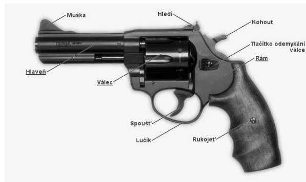
Obrázek 4 Krátká palná zbraň (revolver) s popisky
