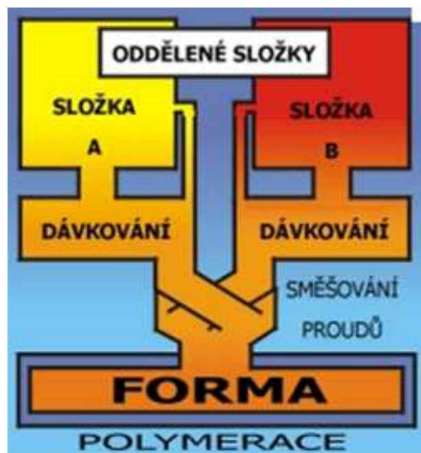
Obr. č. 12: Systém výroby RIM [6]
