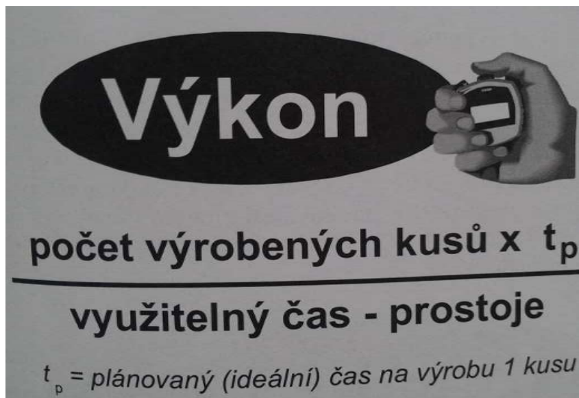
Obr. č. 3: Výpočet parametru výkon stroje [3]
