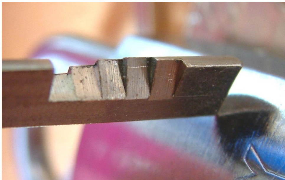
Obrázek 8 Příklad výřezů klíče typu Assa Abloy
