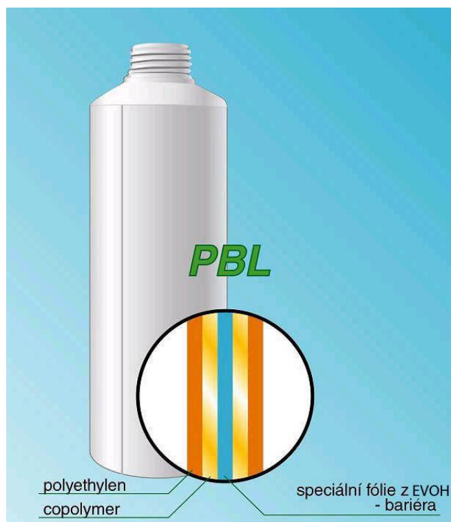
Obr. 3. Laminátový obal s vnitřní bariérovou vrstvou etylenvinylalkoholu [18]
