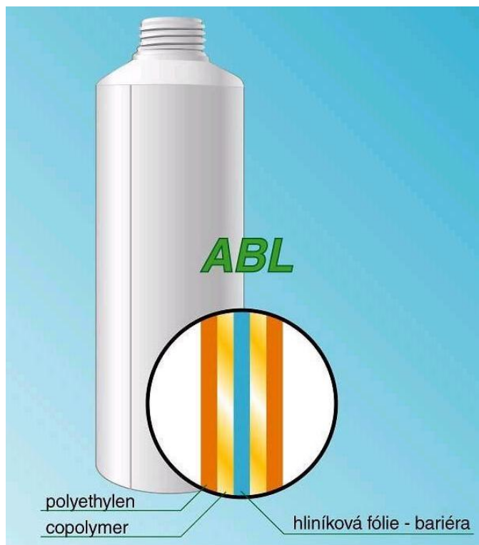
Obr. 2. Laminátový obal vnitřní bariérovou vrstvou hliníku [18]
