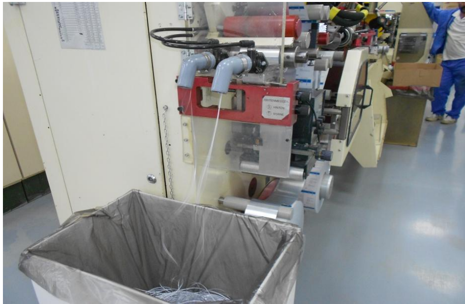
Obr. 4. První fáze výrobního procesu – ořezávání laminátu
