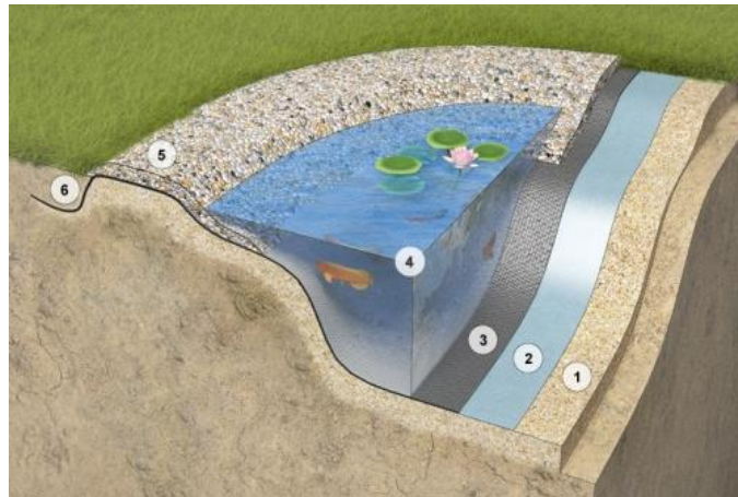
Obr. 11 – Schéma použití hydroizolační fólie k izolaci jezírek [19]
