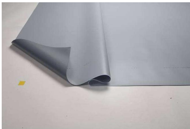
Obr. 6 – Hydroizolační fólie bez výztuže [2]
