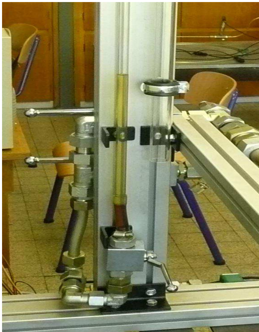
Obr. 5. Detail odměrného válce
