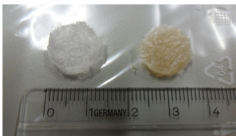
Obrázek 66: Zkušební tělísko NaHy připravené na DMA analýzu.
