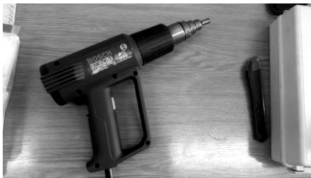
Obr. 6 – Použitá horkovzdušná pistol pro slinování povrchu zkoumaných vzorků PMMA
