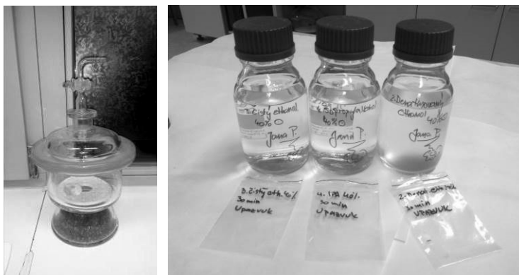
Obr. 2 – Příklady použitého skla, a způsobu skladování vzorků. Sterilní exsikator používaný ke kondicionaci a skladování vzorků PMMA (vlevo), sterilní skleněné lahve se zásobními roztoky a vzorky (vpravo)
