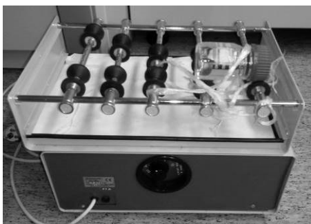
Obr. 3 – Čištění vzorku PMMA ve skleněné lahvi s roztokem na třepačce
