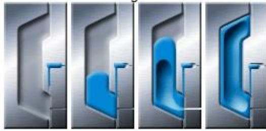
Obr. 13. Fáze vstřikování plynu [16]
