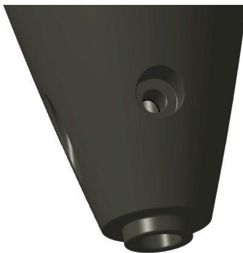
Obr. 38: Zahloubení pro zajišťovací šroub
