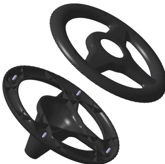
Obr. 34. Podobný díl řešený pomocí montáže ze dvou dílů
