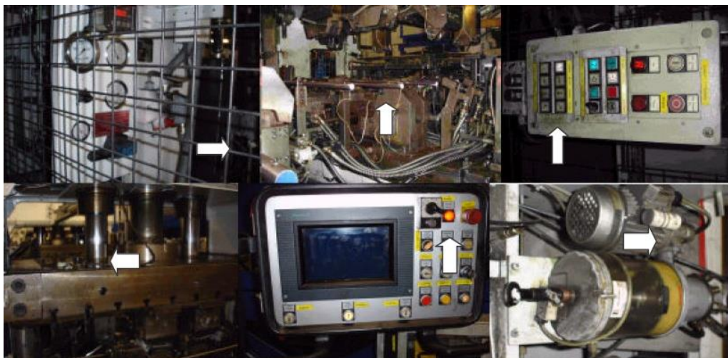
Obr.č.24, Kontrolní činnosti údržby lisu prováděné denně, foceno autorem
