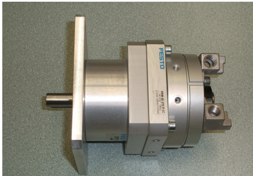
Obr. 38. Kyvný pohon s volnoběžným modulem a redukční deskou
