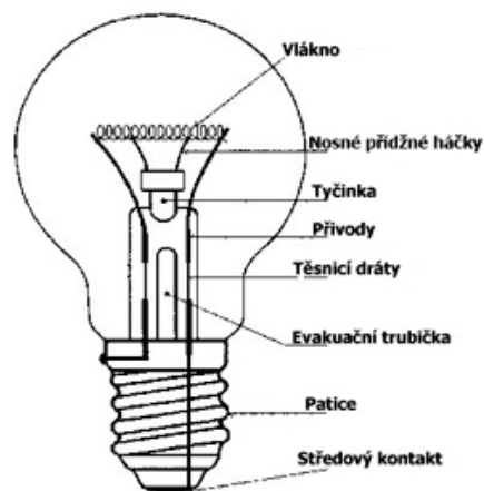
Obr. 5. Stavba žárovky
