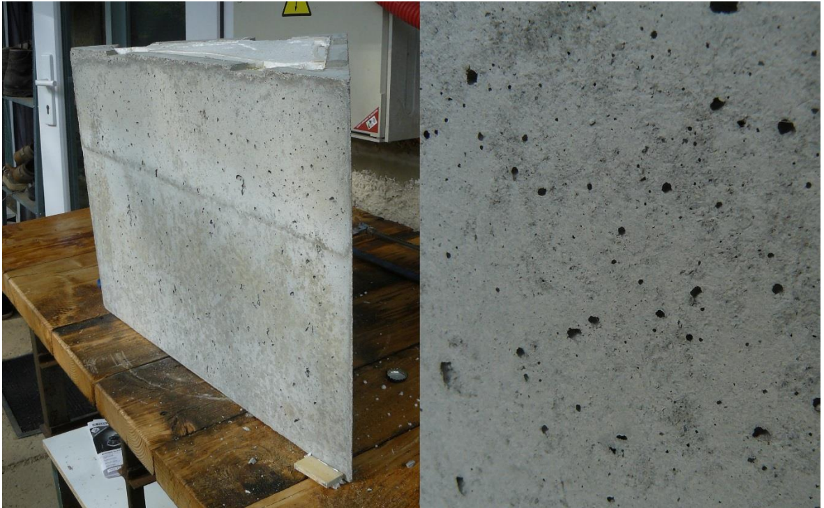
Obr.: 163. Výsledný prototyp ještě před odstraněním polystyrénu středové části
