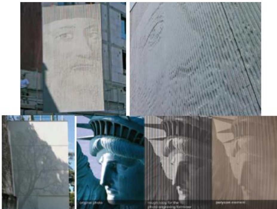
Obr.: 99. Počítačově přenesený obraz frézovací technikou na formu ze dřeva
