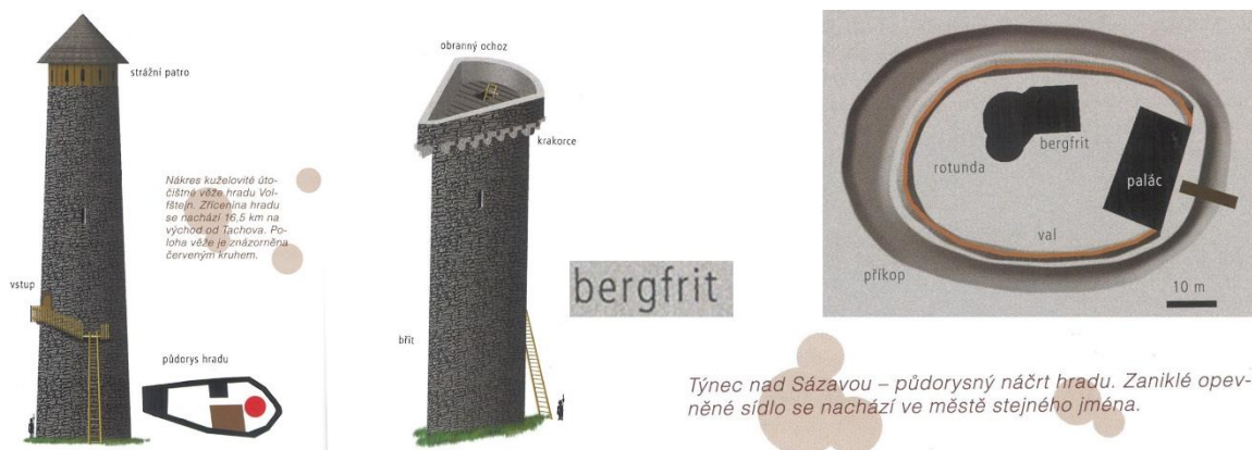
Obr.: 16. Obranné věže a půdorys Týnce nad Sázavou byl zde použit Bergfrit
