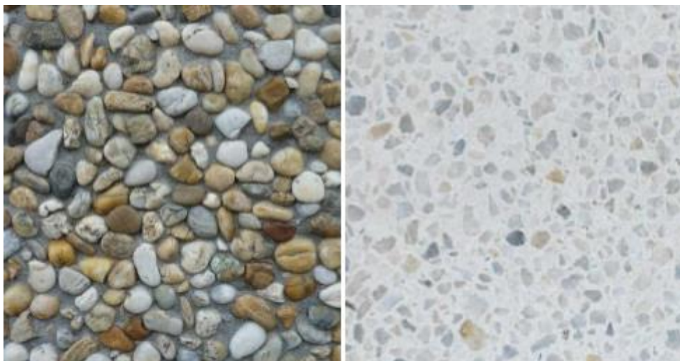
Obr.: 83. Povrchy betonu opracované v tvrdém stavu
