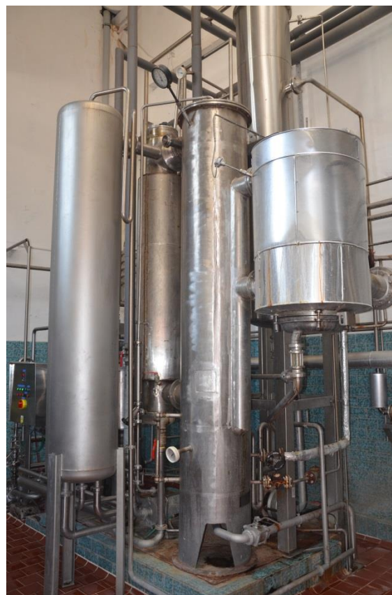
Obr. 3. Jimač aroma – rektifikační kolona.
