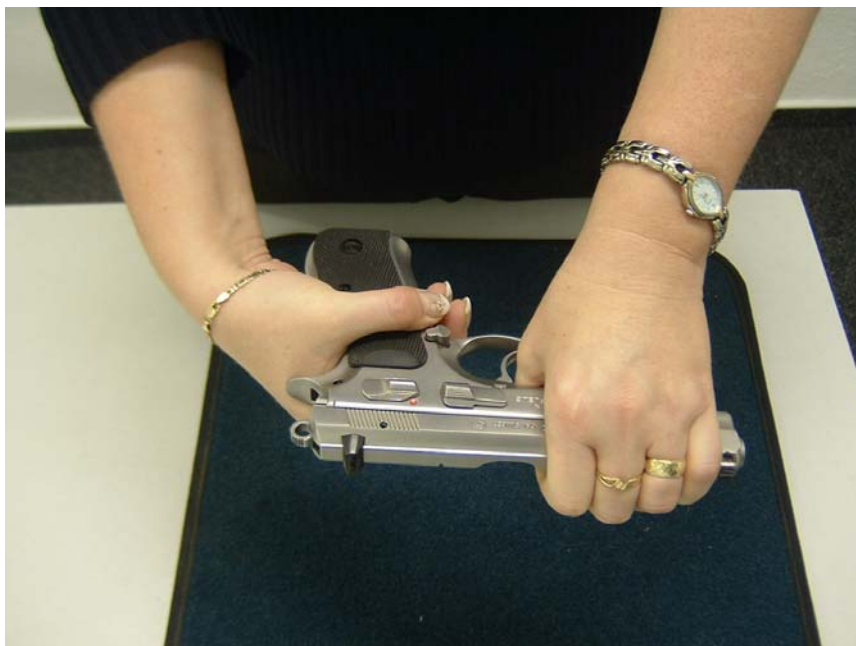
OBR. Č. 27: SROVNÁNÍ RYSEK NA ZÁVĚRU A TĚLU ZBRANĚ
