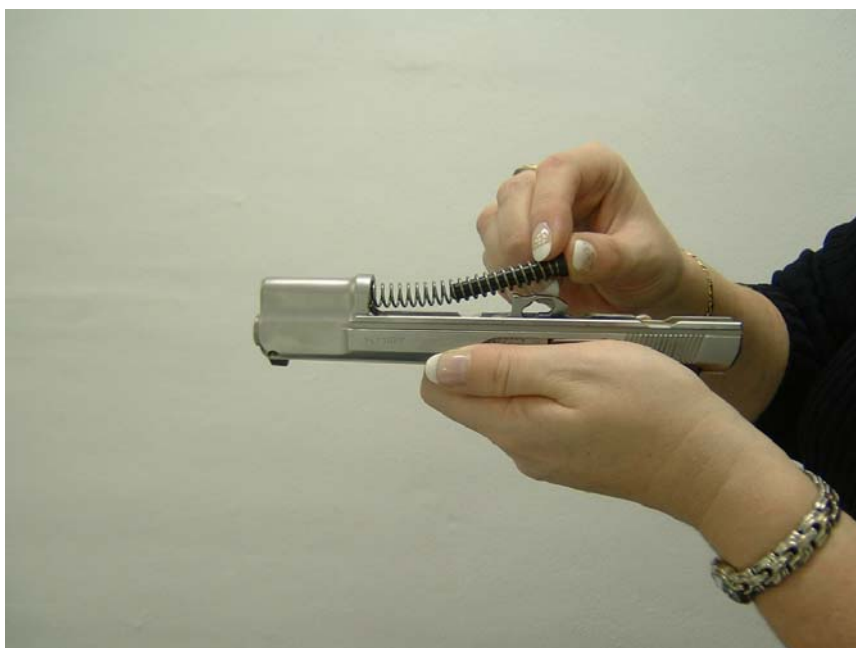
OBR. Č. 30: VYJMUTÍ VRATNÉ PRUŽINY
