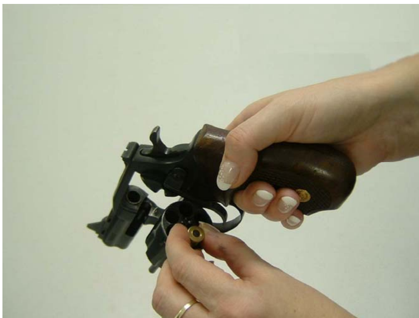
OBR. Č. 18: NABÍJENÍ REVOLVERU
