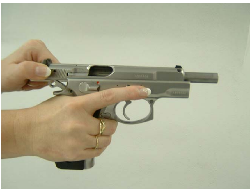
OBR. Č. 15: STAŽENÍ ZÁVĚRU VZAD, KONTROLA NÁBOJOVÉ KOMORY
