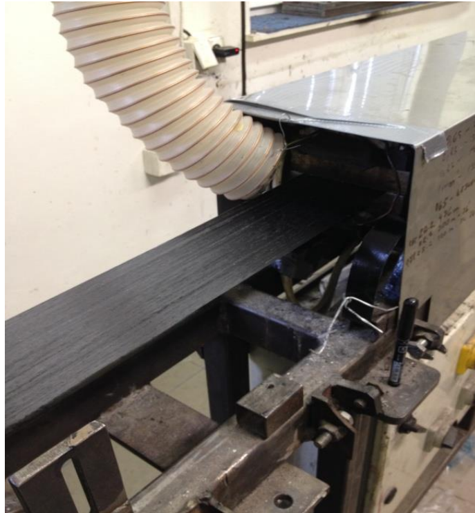
Obrázek 25 Vytvrzovací forma s odtahem materiálu (vlastní zpracování)
