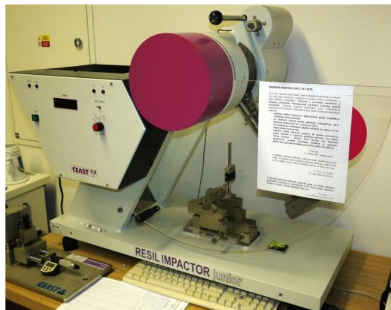
Obrázek 30 Zkušební stroj CEAST RESIL IMPACTOR JUNIOR (vlastní zpracování)
