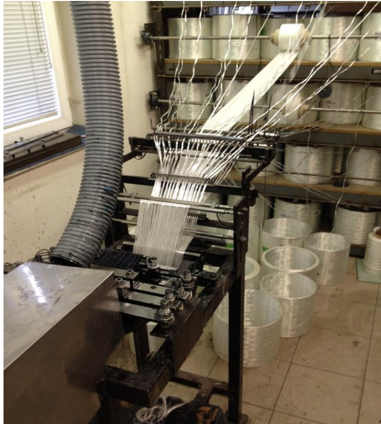
Obrázek 24 Navádění rovingů do srovnávacích hřebenů (vlastní zpracování)
