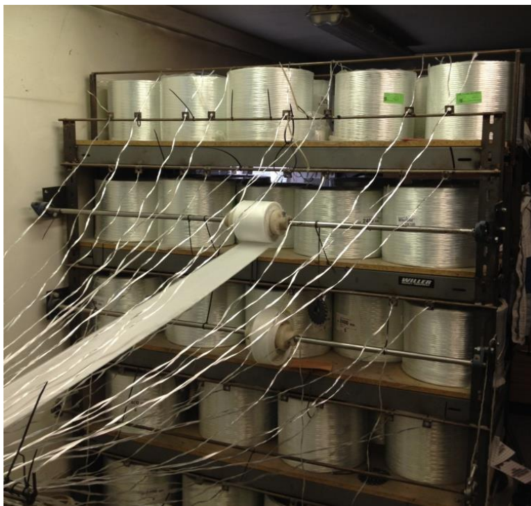
Obrázek 23 Umístění a navádění rovingů (vlastní zpracování)
