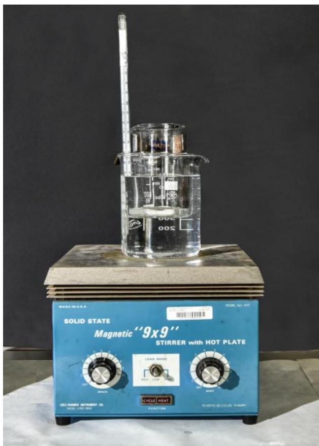
Obr. 15: Míchání směsi na vodní lázni při teplotě 80 °C
