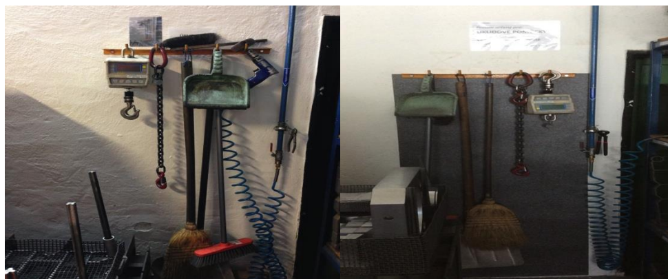
Obr. 42 Úklidové prostředky před a po zavedení 5S a označení prostoru
