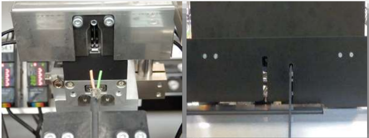
Obr. 25. Původní krok vládání vodiče do stroje (vlevo), nové řešení vládání vodiče (vpravo). (vlastní zpracování)
