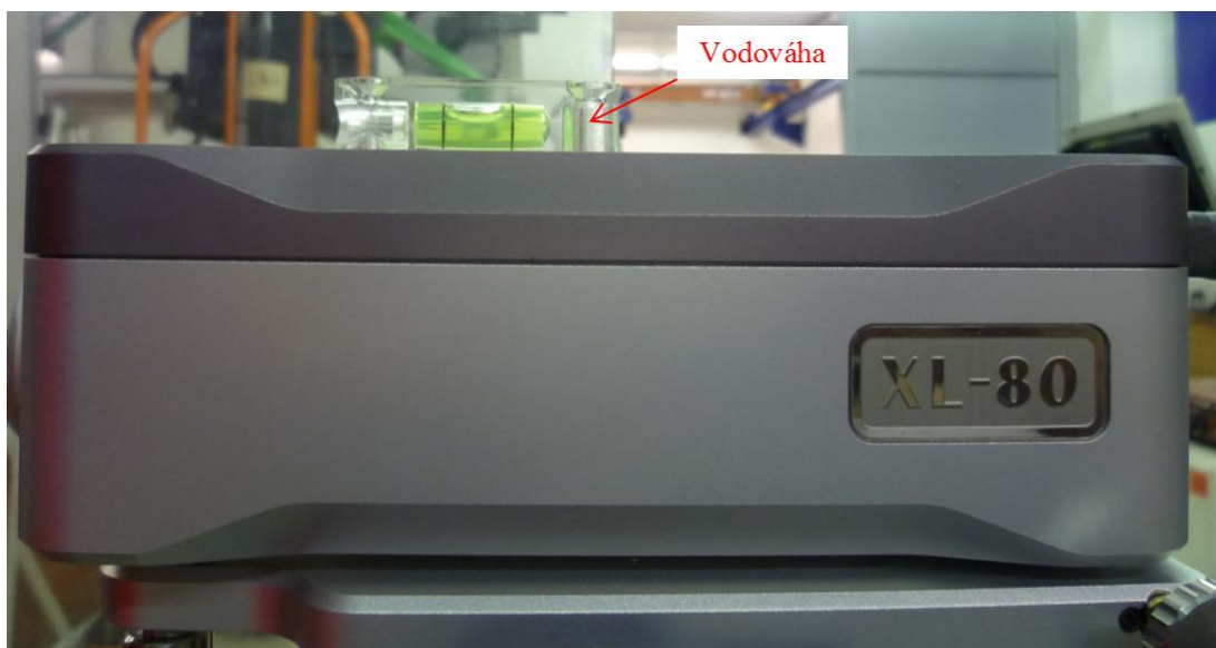
Obr. 22. Vyrovnání laserové hlavy pomocí vodováhy
