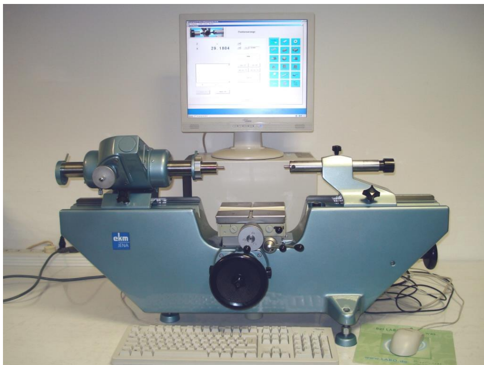
Obr. 20. Zdigitalizovaný délkoměr Zeiss ULM 450 [15]
