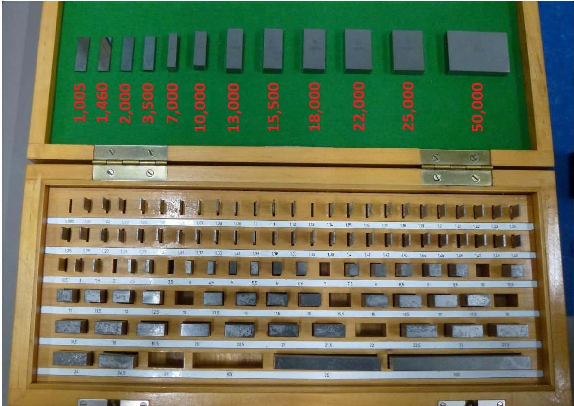
Obr. 40. 12 vybraných koncových měrek a jejich hodnoty v mm
