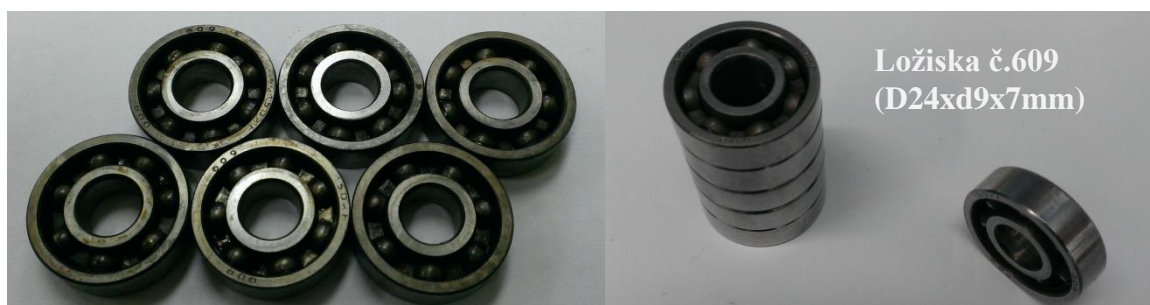
Obr. 24. Ložiska vedení hřídele před a po renovaci
