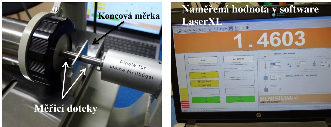
Obr. 43. Měření koncové měrky délky 1,46 mm jako příklad kalibrace
