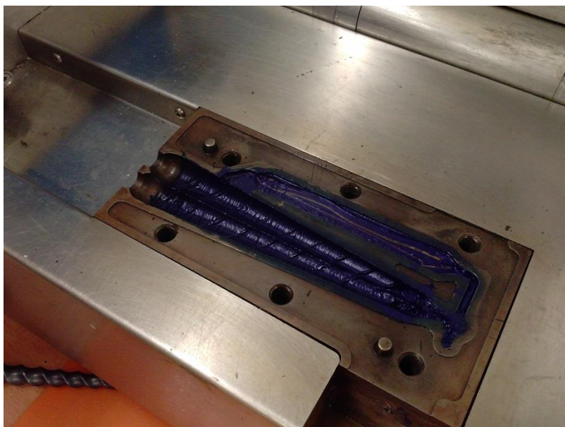
Obrázek 18 – Mikrohnětič Haake Minilab
