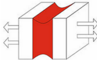
Obr. 10: Metóda odtrhávania čelných spojov [28]
