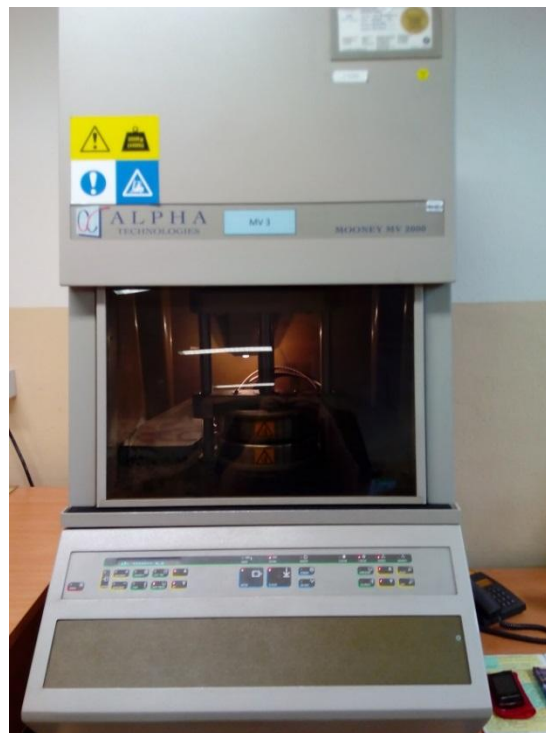
Obr. 34: Viskozimeter Mooney MV 2000 od spoločnosti Alpha Technologies
