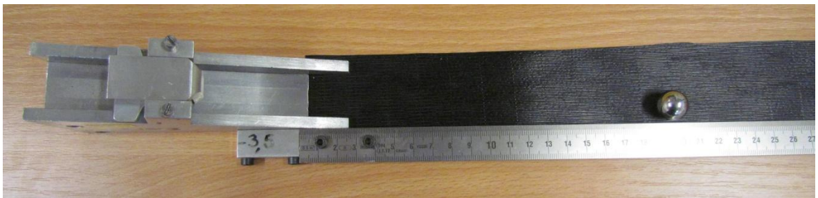
Obr. 20: Meranie lepidivosti pomocou metódy Rolling Ball
