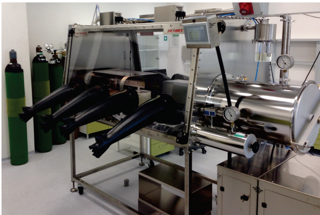
Obrázek 9 : Materiálová tiskárna FUJIFILM Dimatix model DMP-2831 umístěná v Gloveboxu v laboratořích CPS.
