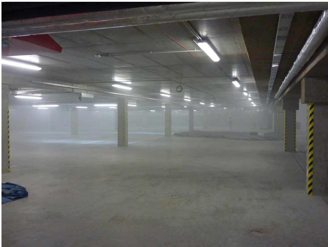
Obr. 9: Cca 10 minuta kouřové zkoušky [28]
