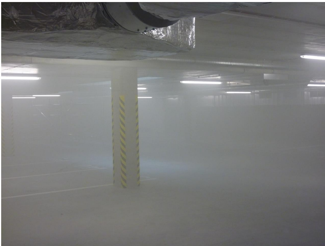
Obr. 8: Zakouření prostoru garáže v cca 7 minutě [28]
