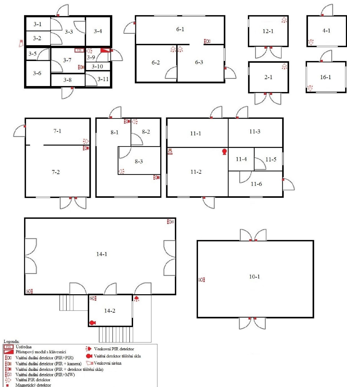
Obr. 44 Návrh zabezpečení objektů č. 2, 3, 4, 6, 7, 8, 10, 11, 12, 14, 16
