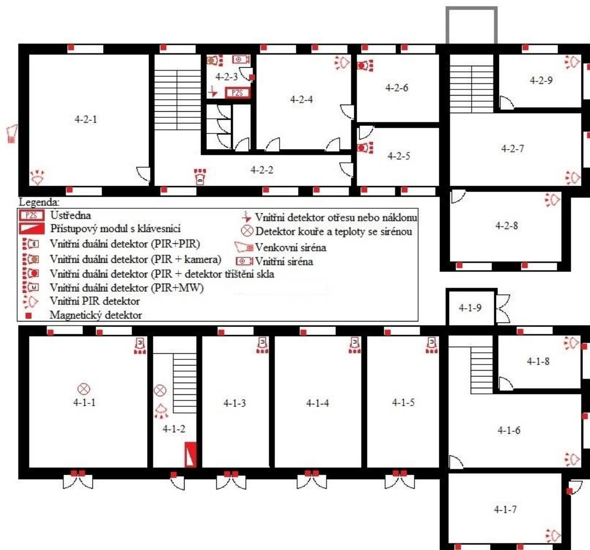
Obr. 40 Návrh zabezpečení objektu č. 4
