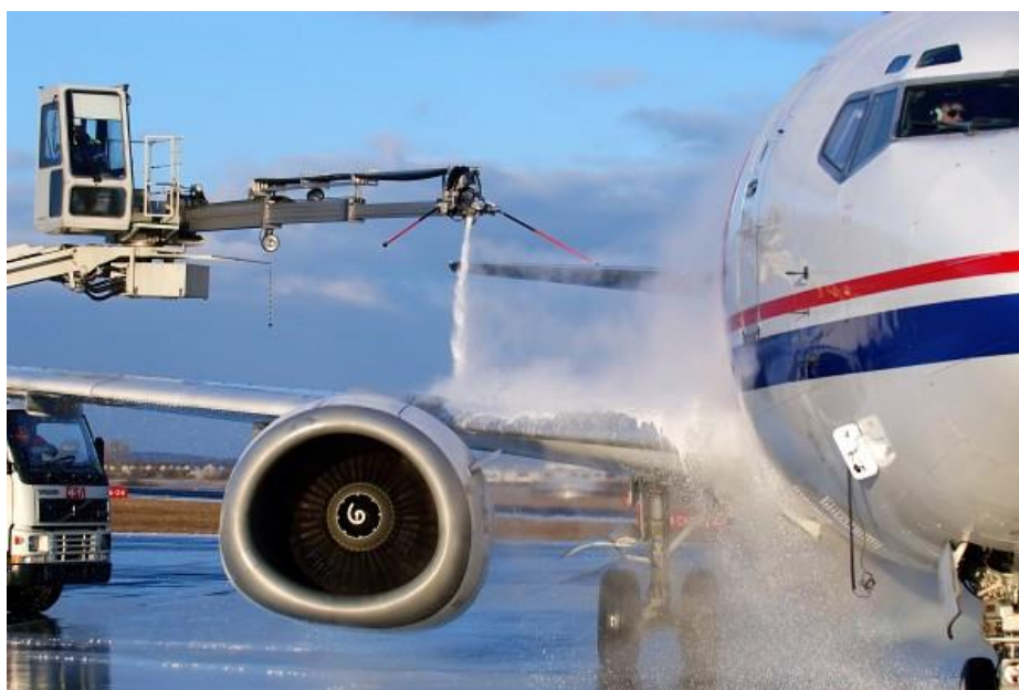
Obr. 10. Speciální odmrazovací technika ošetřující plochy letadla [Zdroj: 10]
