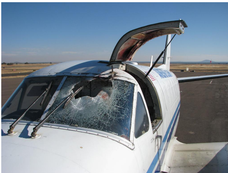
Obr. 12. Výsledek střetu malého sportovního letadla s ptákem [Zdroj: 7]
