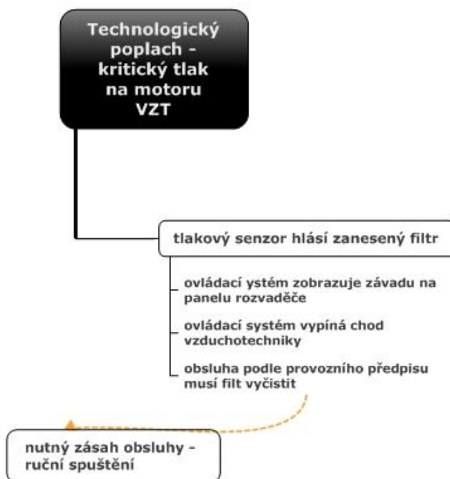
Obr. 10. Kritický tlak na motoru vzduchotechniky
