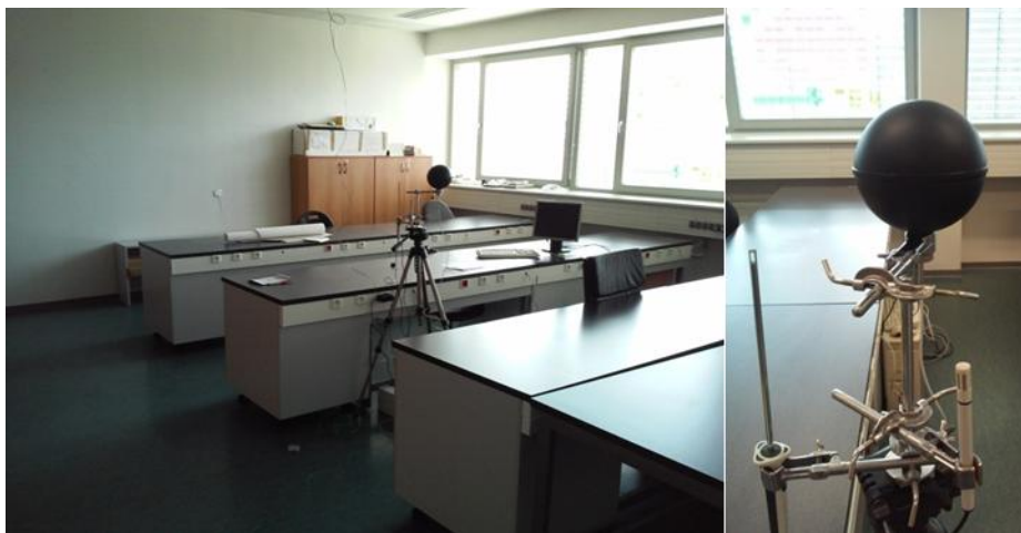
Obr. 9. Umiestnenie statívu s meracími sondami v strede miestnosti
