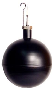
Obr. 13. Gul'ový teplomer ZA 9030 FS2[39]
