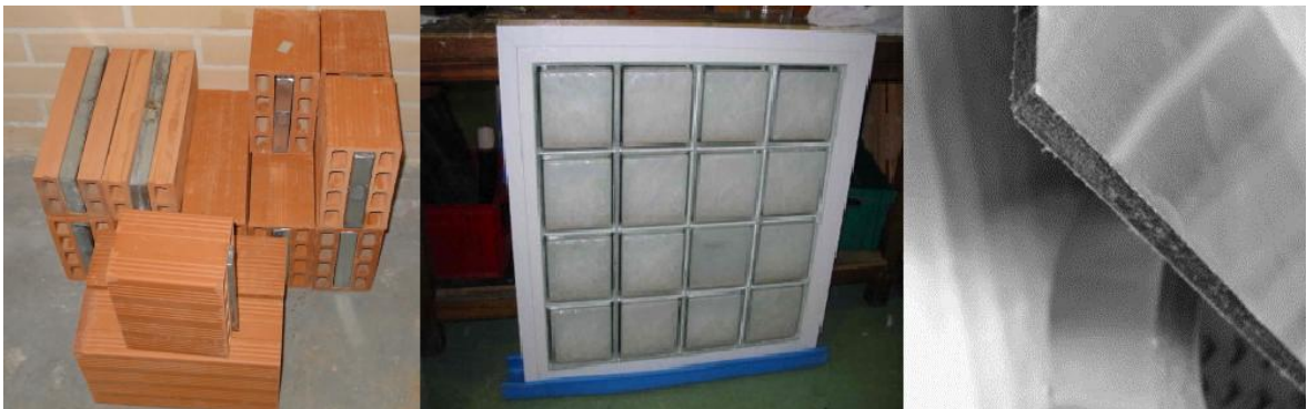
Obr. 5. Materiáli s PCM, vľavo- tehly s PCM, vstrebe – sklenené tehly s PCM, vpravo - kompozitná doska [28]
