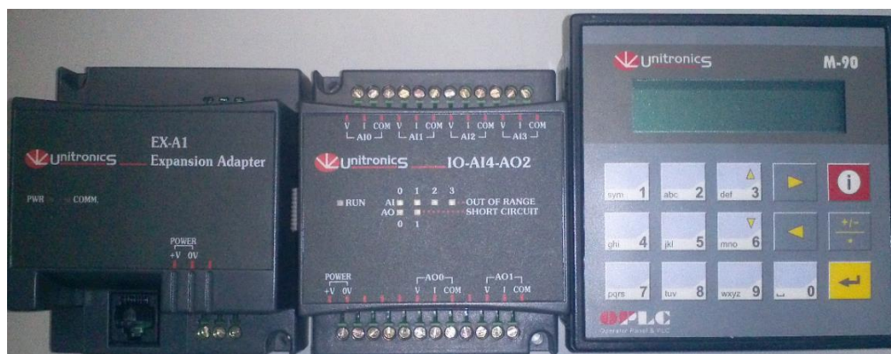
Obr. 35. Kompletní výbava PLC Unitronics
