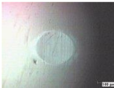
Obr. 10 Abrazivní otěr na kuličce
