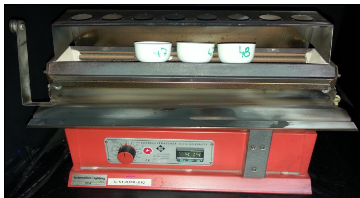
Obr. 75. Odstranění těkavých látek
