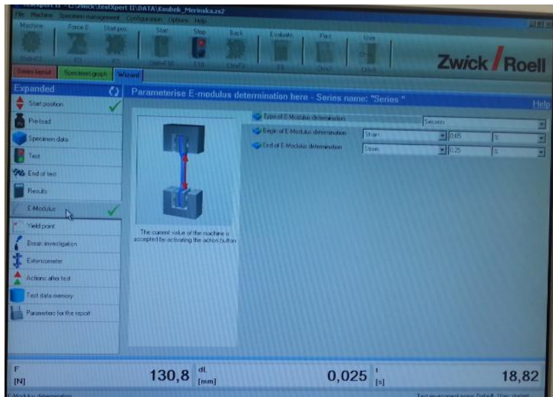
Obr. 52. Nastavení E – Modulu
