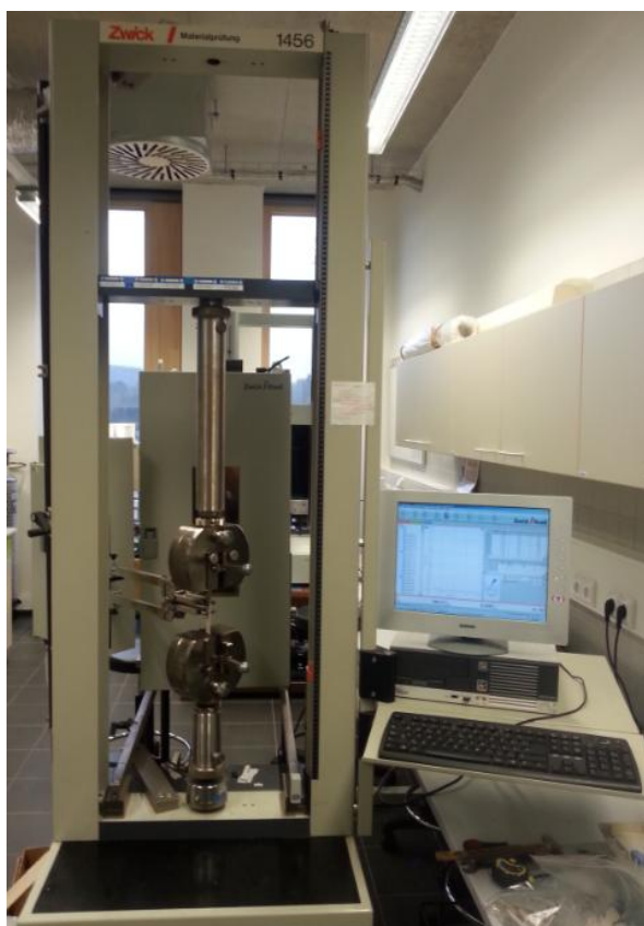
Obr. 49. Pracoviště tahové zkoušky
