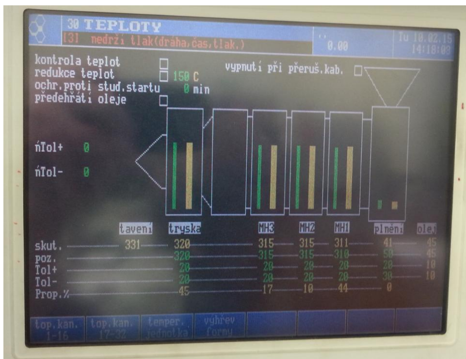
Obr. 46. Hodnoty vyhřívání jednotlivých částí vstřikovací jednotky pro směsi z PC
