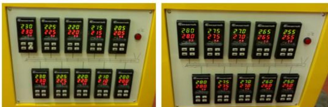
Obr. 35. Nastavení optimálních teplot pro vytlačování
