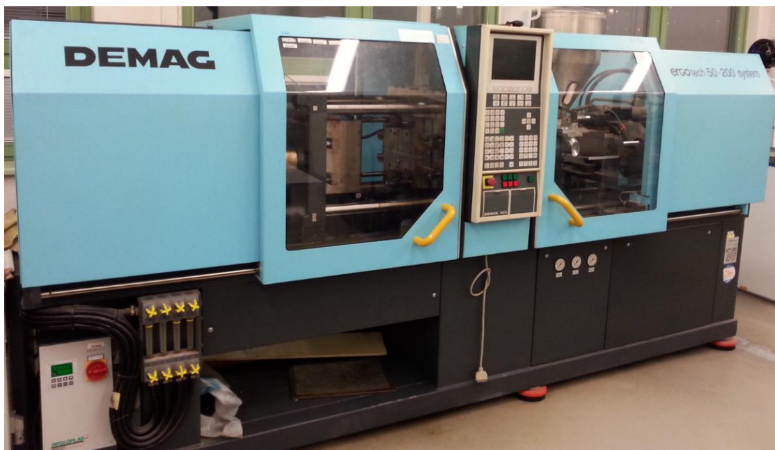
Obr. 40. Vstřikovací stroj DEMAG
