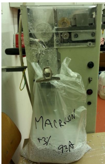
Obr. 38. Mletí vytlačené struny ze směsi PC + 3 % 93A
