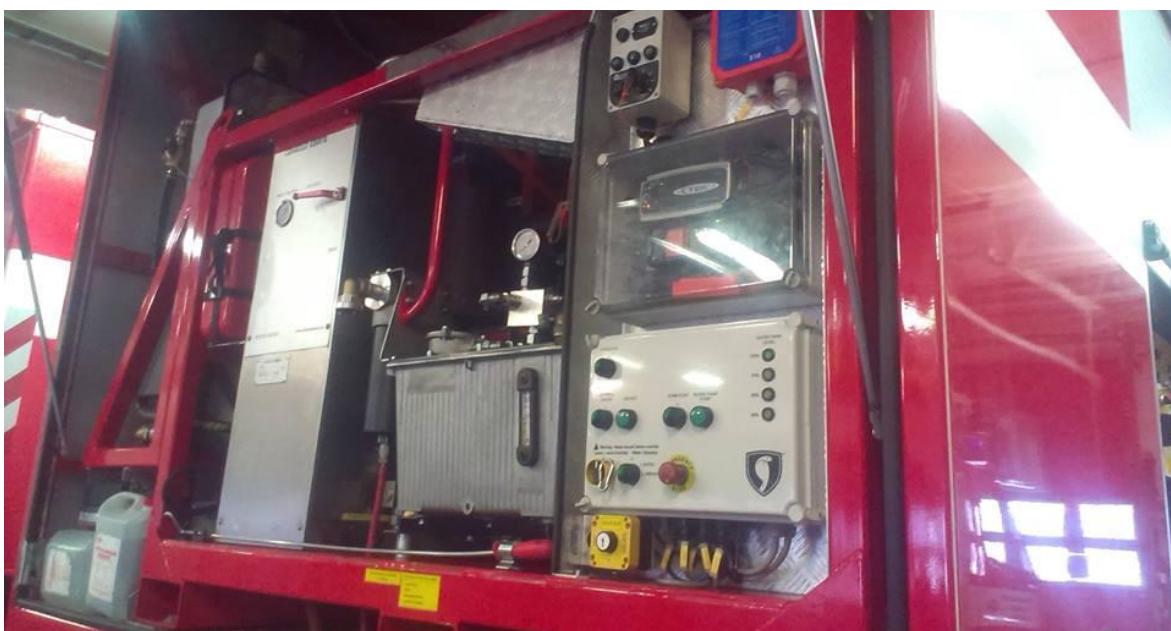
Speciál stanice HZS Olomouc se zařízením pro řezání vodním paprskem s možností přimísení abraziva CCS Cobra C 360 HLS Kit. Řezací zařízení je určené pro řezání stavebních konstrukcí (zejména materiálů: zdivo, beton, ocel, sklo, pryž, dřevo). (vlastní)
