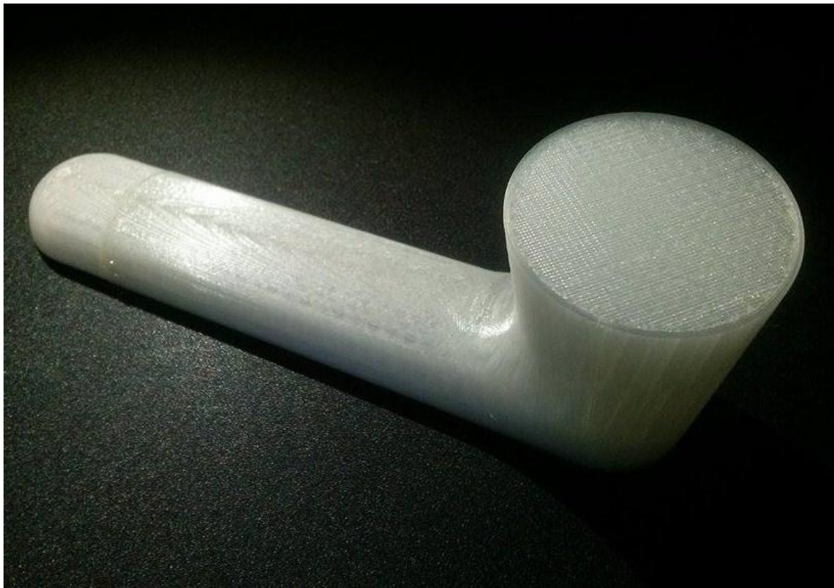
Obrázok 51. Nevyretušovaný plastový model z 3D tlačiarne
