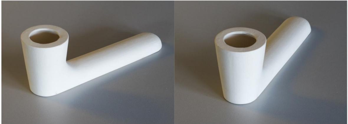
Obrázok 54. Porcelánové polotovary po prvom pálení
